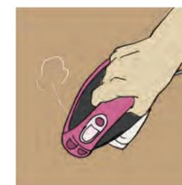
⑦熱したアイロンを、ウエスの上に置きます。蒸気が木の細胞に入り込み、へこみを目立たなくします。乾いたら②～④の行程で仕上げて下さい。
