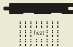
木材を高温で熱処理し、寸法安定性と防腐性と対候性を向上させています。
