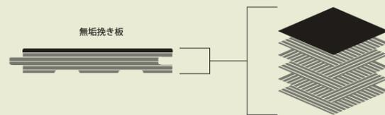
表面に貼った3mmの無垢挽き板と、その他の材を積層した下地から構成されたフローリング。無垢材を床暖房で使用する際に起こる、ワレや反り、ねじれを、下地が打ち消します。形状安定性と、贅沢な幅広を両立しているのが魅力です。
